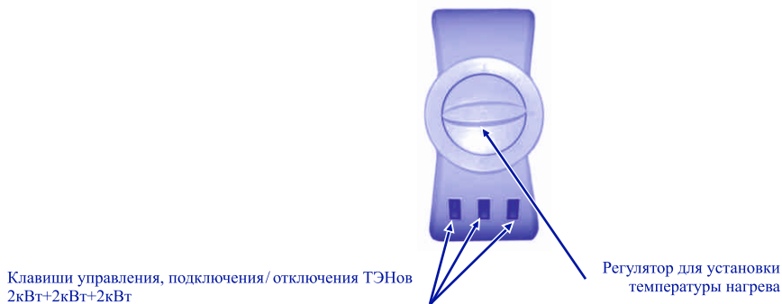
Рис.2. Расположение функциональных кнопок блока управления.
