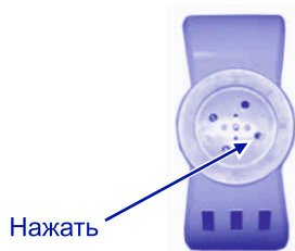
Рис.3. Расположение штока на термовыключателе термостата
